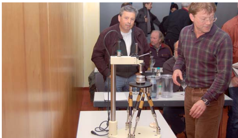
Der Hexapod setzt die Computerdaten in die Bohrschablone um.
