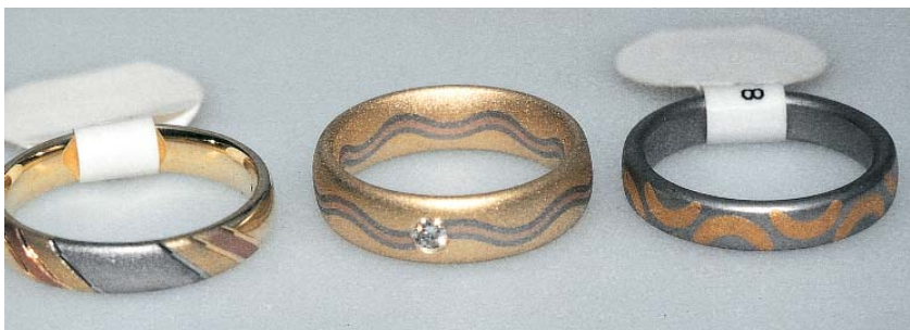
Ringe, gefertigt in verschiedenen Herstellungsverfahren von l. nach r.: Löttechnik, Sintertechnik, Einschmelztechnik
