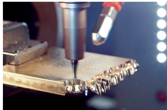
Abb. 3a: Frästechnische Bearbeitung von Edelmetall.
