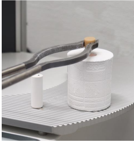
Muffel mit Rohling bestücken
