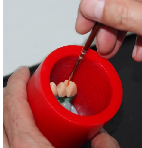
Innenvolumen der Kronen mit Einbettmasse auffüllen
