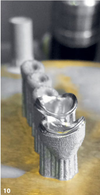
Abb. 10 Die gedruckten Bauteile werden auf der Bauplatte in der Hochleistungsfräsmaschine nachgefräst. Abb. 11 Supportmodul Materialise Magics mit seinen vielseitigen Parametern.
