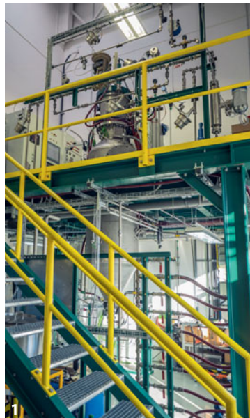
Abb. 1 Pulververdünsungsanlage bei C.Hafner. Abb. 2 Schmelzstrahl beim Verdüsen von Metallen (schematische Darstellung)
