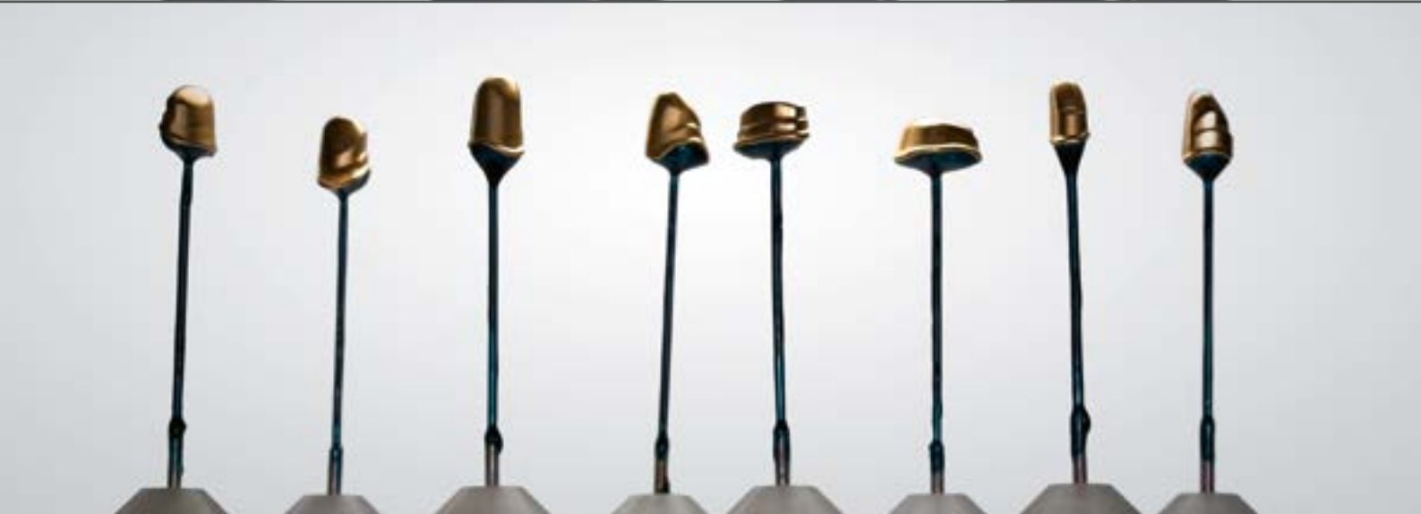
08 & 09 Die mit Leitsilber-Lack benetzten Primärteile vor dem Galvanisieren (links) und dieselben Teile nach der Galvanisierung.
