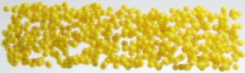
13 Kristallgitter galvanisch abgeschieden ca. 140 HV/5
