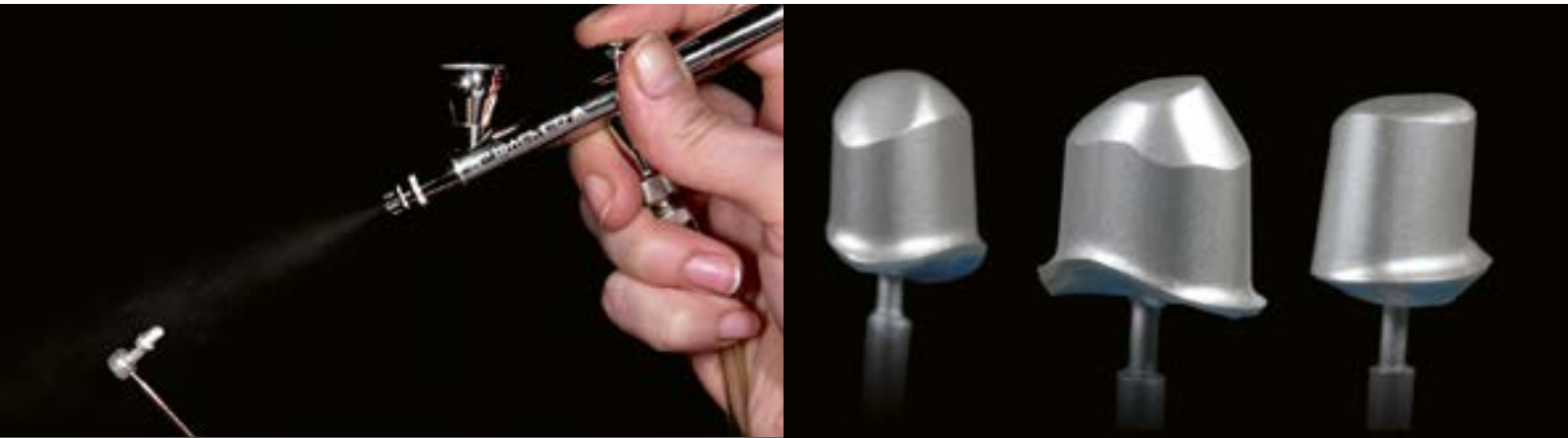
06 & 07 Der für das elektrochemische Auftragen benötigte Leitsilber-Lack kann auf mehrere Arten auf die Primärkronen aufgetragen werden. Zum Beispiel mittels Airbrush-Technik.
