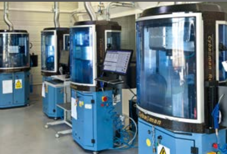
12 Leistungsstarke Bearbeitungszentren mit automatisiertem Blankwechsel bilden die Basis des Fertigungsservices „Fräsen in Edelmetall“
