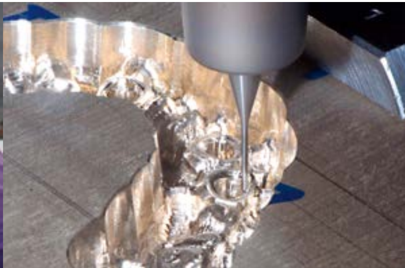
11 Für jeden Legierungstyp kommt eine eigens entwickelte Frässtrategie zum Einsatz
