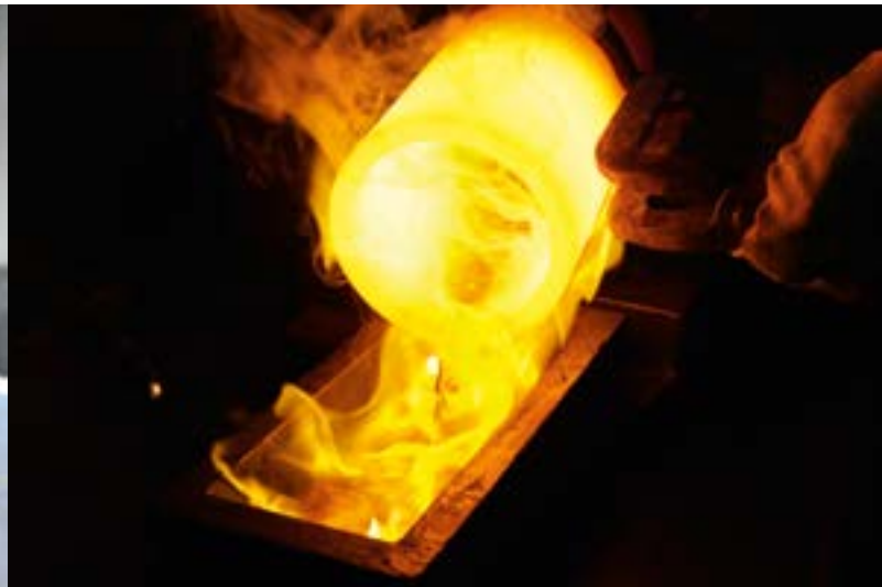
15 Aufschmelzen des Scheidguts, wie es beim subtraktiven Fertigungsservice „cehaGold“ anfällt
