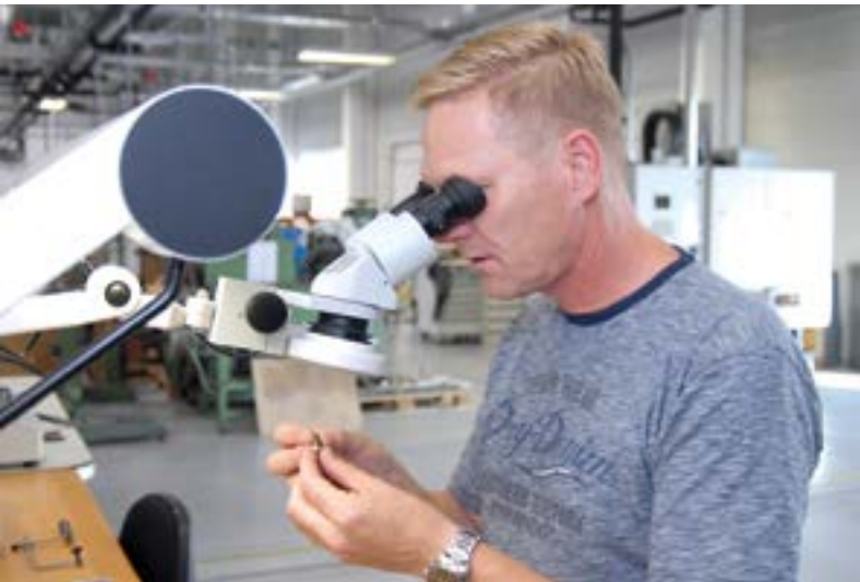
14 Die finale Kontrolle der gefrästen Goldobjekte erfolgt unter Zuhilfenahme des Mikroskops
