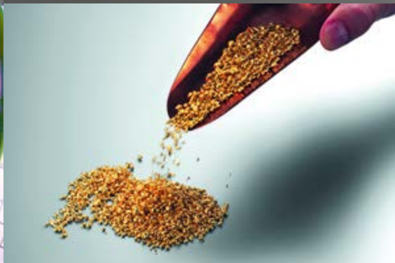
16 & 17 In einem schnellen und effektiven Recyclingprozess werden die beim Fräsprozess entstandenen Gold-Späne in der C.Hafner-eigenen Scheideanstalt rückgewonnen
